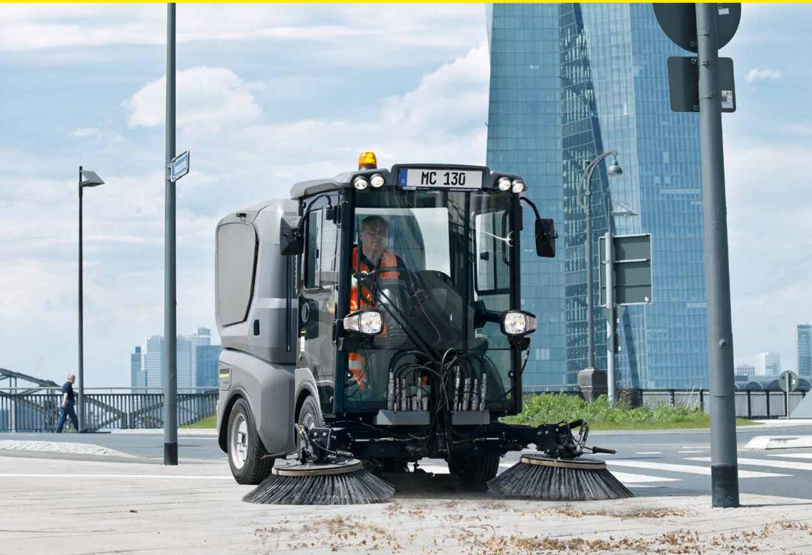
Optez en faveur d'un espace optimal et – au choix – d'une cabine pour une ou deux personnes avec un système de protection en cas de retournement (ROPS). Misez sur la sécurité par la vision panoramique à 360° sans obstacles, par la transmission intégrale hydraulique permanente et par l'entraînement hydraulique d'outils qui peut être freiné.
